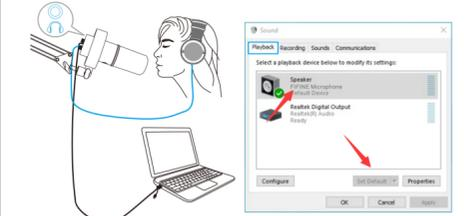
б. Щелкните Динамик (микрофон FIFINE ) - Свойства Levels и перетащите индикатор выполнения, чтобы настроить громкость вывода .
